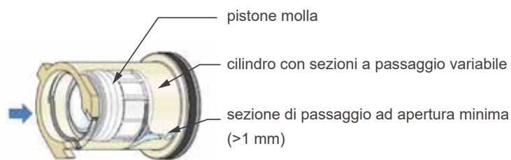
Rappresentazione interna di una valvola di bilanciamento dinamica per l'ACS (Caleffi)
